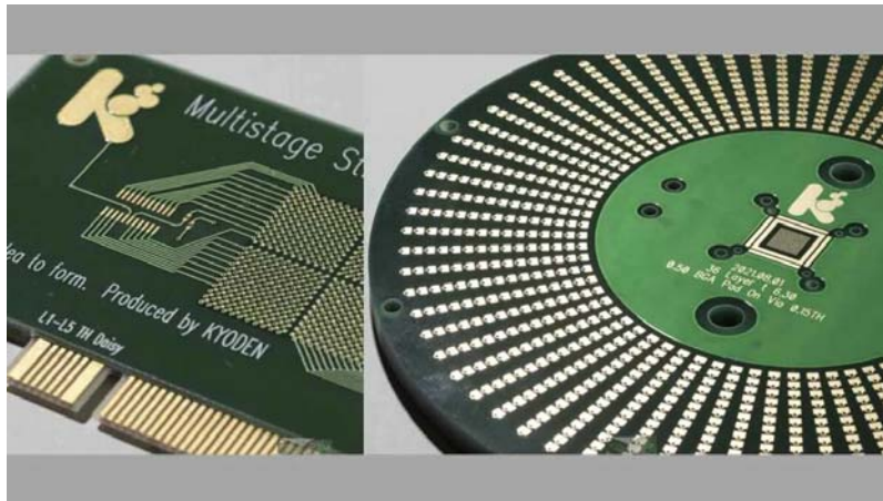
左側が6層の複合導体/厚銅基板で、右側は36層のパーインボード。いずれも高機能基板だ(写真:キョウデン提供)
